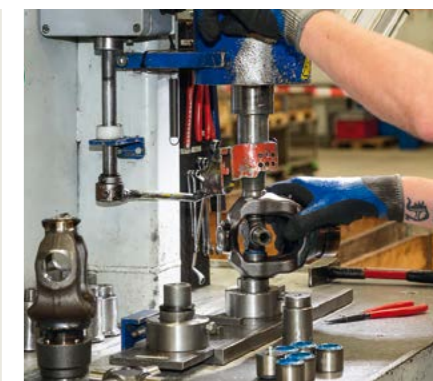
Die zum Teil vormontierten Gelenke werden in Wijchen komplettiert.
